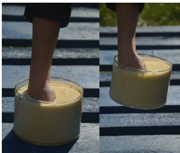
obr. 23 Zdvíhanie nádoby pomocou nenewtonovskej kvapaliny
